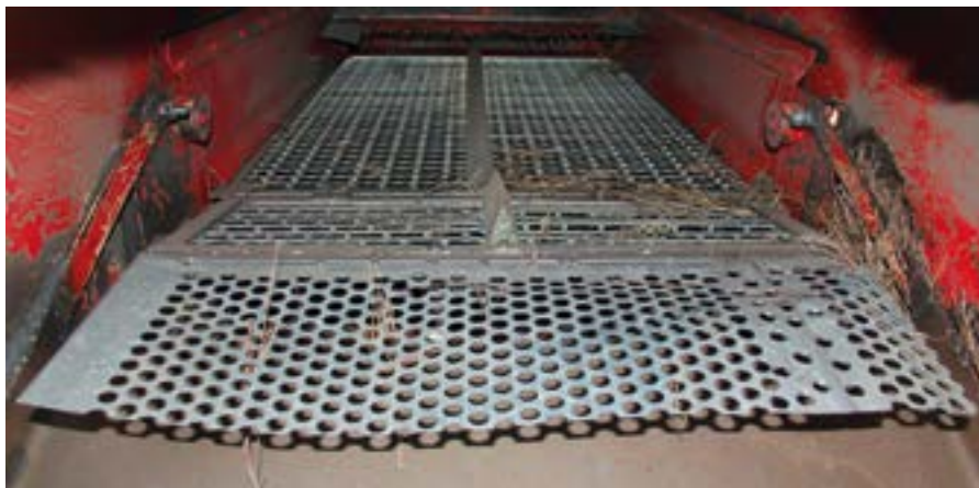
Górny ciąg sitowy w kombajnie rolnika spod Radziejowa składa się kolejno z: części głównej marki Osko-Plast, fabrycznego odcinka kłosowego oraz dołożonego gospodarskiego segmentu oczkowego.
