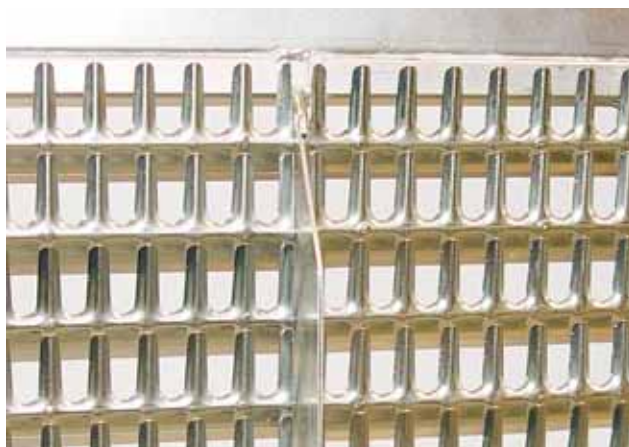
Sito kukurydziane CZ3 cechuje się końcówkami lamel o długości 32 mm i rozstawem drucików je mocujących 40 mm.
