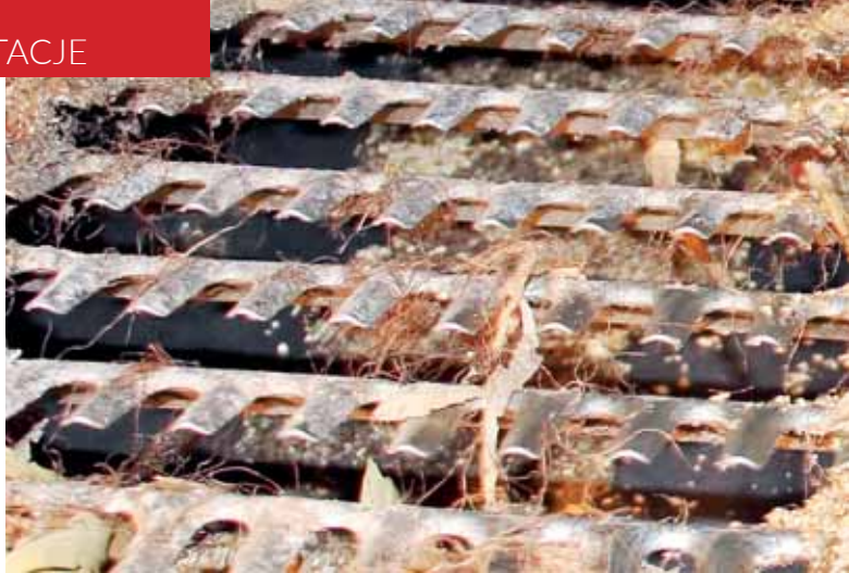
Podczas naszej wizyty sito Osko-Plastu było ustawione na 12 mm.
